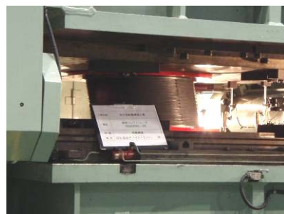
積層ゴム支承の性能検査
