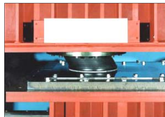
弾性すべり支承の性能検査例
