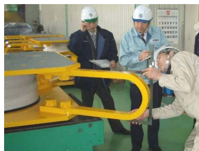
U型ダンパー付積層ゴム支承の寸法検査
