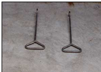
マンホールハンドル
