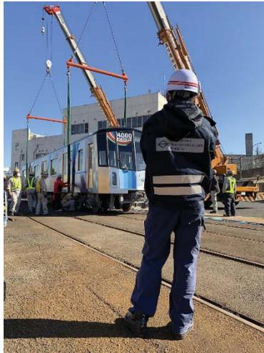
走行試験の一つが、荷重試験です。お客様がご乗車されている状況でも性能が確保できることを確認するため、荷重水槽と呼んでいるタンクを電車に積み、そこに注水し、お客様がご乗車されている状態を模擬して走行確認を行います。1編成に約50個のタンク、その中に40t以上の水を入れて積み込みます。この試験は約2週間程、水が漏れないか心配しながらタンクと一緒に乗車し、性能の確認を行います。
