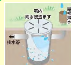
宅内雨水浸透ます
