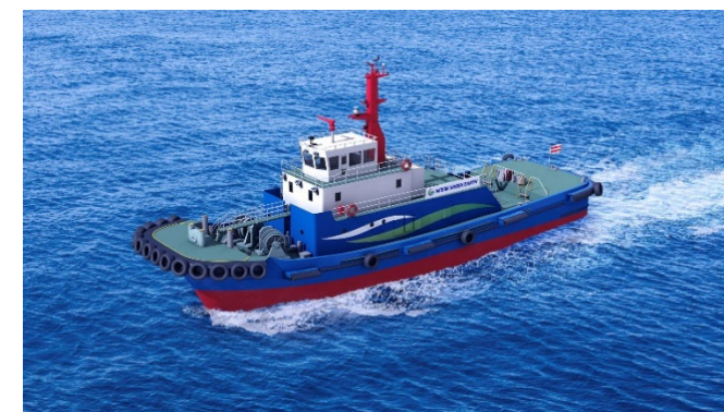
アンモニア燃料タグボート（日本郵船（株）提供）
