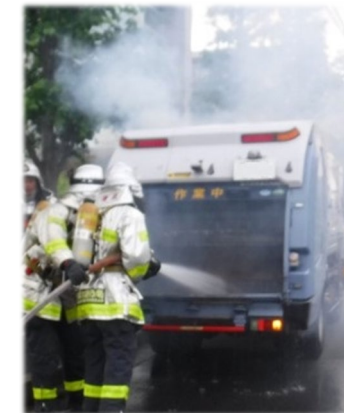
バッテリーに圧力がかかり 発火
