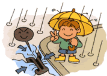
雨水を下水管に取り込む雨水ます
