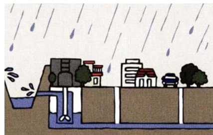
雨水を汲み上げて川に排水するポンプ施設
