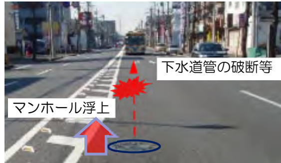
緊急輸送路の下水道管の耐震化
