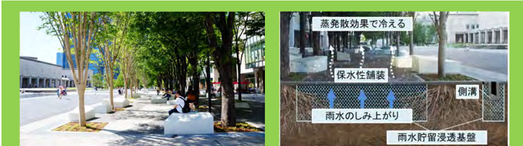
◆公園連携：公園の新設・再整備の機会に浸透機能を向上 (グランモール公園の例)
