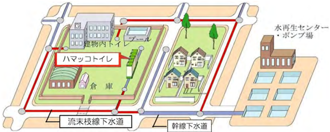
地域防災拠点等につながる流末枝線下水道（赤線で表示）の模式図
