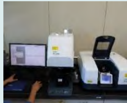
FT-IR（フーリエ変換赤外分光光度計）
