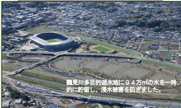
鶴見川多目的遊水地に9.4万㎡の水を一時的に貯留し、浸水被害を防ぎました。
