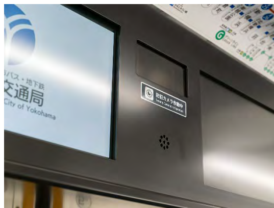
車内防犯カメラ（4000形）
