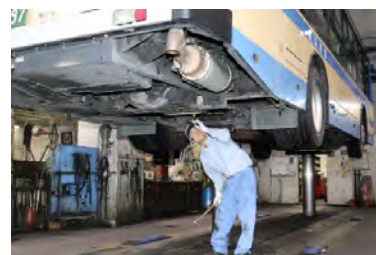
バス車両整備工場の整備用リフト
