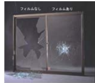
窓ガラス飛散防止フィルムの効果 (左：フィルムなし 右：フィルムあり)
